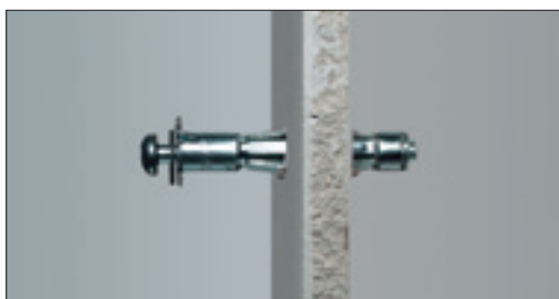
2. Inserire l'ancorante nel foro, fino a che la testa dell'ancorante non abbia raggiunto il pannello
